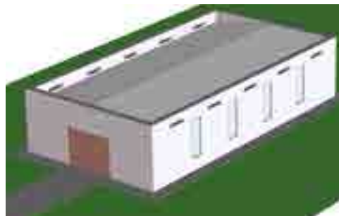
Slika 5: Ilustracija rješenja sekundarne odvodnje s pravokutnim otvorima
